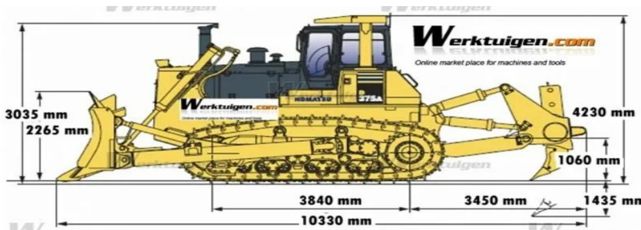
8 Сурет-Таңдалған Komatsu 375A-5 2 бульдозері Бетон тасымалдау көлік түрін таңдау және санын анықтау.
